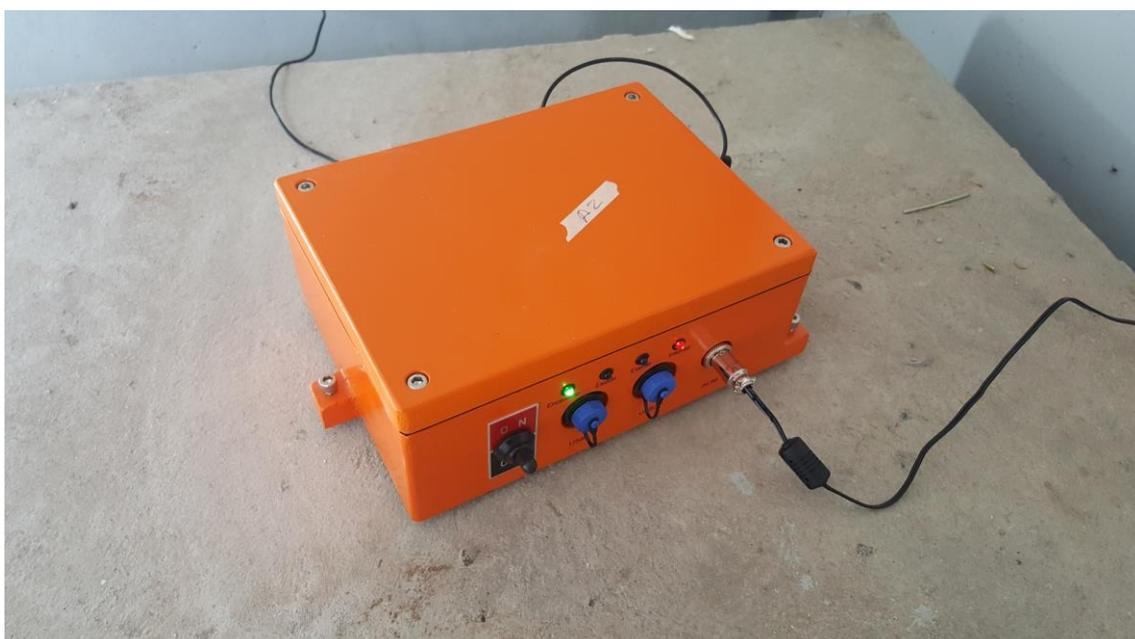
Diseño en 3D y fabricación de gabinete para sensores de temperatura
