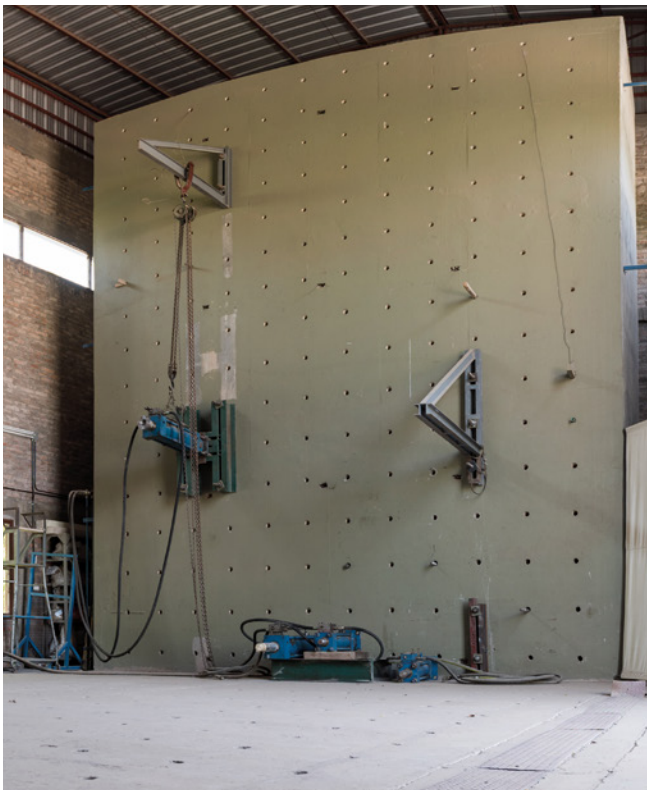
Losa de carga y muro reactivo Laboratorio de estructuras
